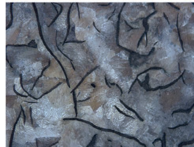
Mikrostruktura żeliwa z grafitem laminarnym
