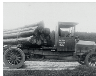
Ciężarówka M.A.N.-Saurer z 1915 roku od razu okazała się przebojem, ponieważ wyposażona była w hamulec silnikowy. Nastawnik na kole kierownicy pozwalał tak przestawić sterowanie rozrzędem, że podczas hamowania silnikiem ten pracował jak kompresor hamujący pojazd.
