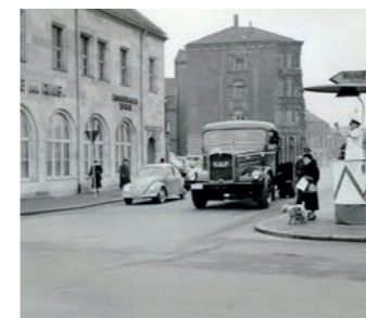
M.A.N. F8 z silnikiem V8 o mocy 180 KM. Zastosowanie silnika w układzie „V” pozwoliło na skrócenie kabiny bez zabierania miejsca w jej wnętrzu.
