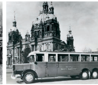
Model S1H6 to na początku lat 30. XX wieku najmocniejsza ciężarówka z silnikiem Diesla. Ponadto był to pierwszy trzyosiowy pojazd ciężarowy w ofercie firmy. Na tym samym zespole napędowym osadzono też nadwozie autobusu.
