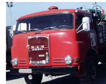
M.A.N. zwany potocznie „Pausbacke” był wynikiem nowelizacji w 1960 roku niemieckich przepisów o transporcie ograniczających długość samochodów ciężarowych. Zmieszczenie silnika pod kabiną spowodowało jej poszerzenie.
