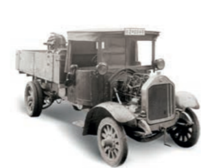
Pierwsza ciężarówka wyposażona w silnik Diesla. Jednostka napędowa miała 4 cylindry o średnicy 105 mm i moc 40 KM osiąganą przy 1000 obr./min., a innowacją w niej był bezpośredni wtrysk paliwa. Silnik ważył 420 kg.
