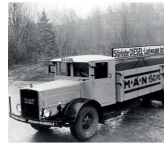
Model S1H6 to na początku lat 30. XX wieku najmocniejsza ciężarówka z silnikiem Diesla. Ponadto był to pierwszy trzyosiowy pojazd ciężarowy w ofercie firmy. Na tym samym zespole napędowym osadzono też nadwozie autobusu.
