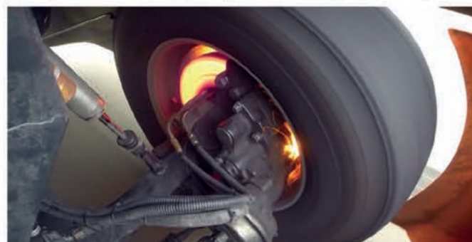
Wysokie temperatury powodują żarzenie tarczy hamulcowej
