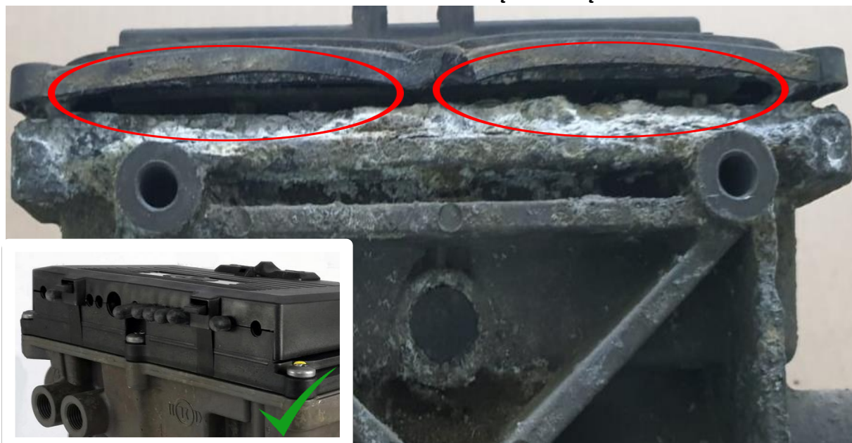
UTLENIONY KORPUS ALUMINIOWY PRZYLEGAJĄCY DO CZĘŚCI ELEKTRONICZNEJ
