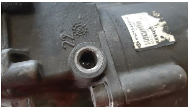
WODA W UKŁADZIE, MOŻLIWE ZALANIE ELEKTRONIKI
