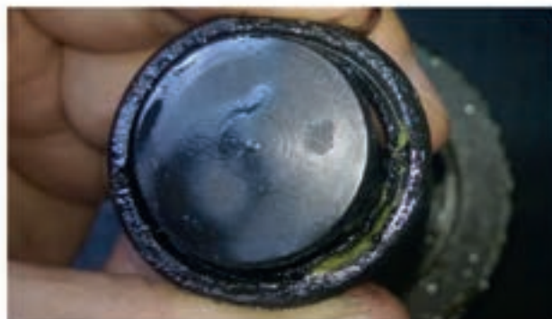
O-ring speczęniał w wyniku działania niewłaściwie zastosowanego medium robocznego
