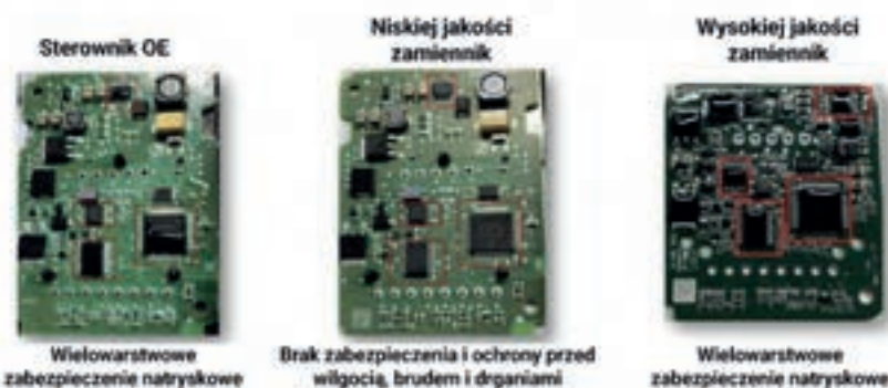
Ilustracja 2. Różne standardy wykonania sterownika czujnika NOx. Źródło: Dinex.
