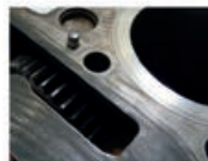
Powierzchnia robocza bloku silnika z kołem rozrządu
