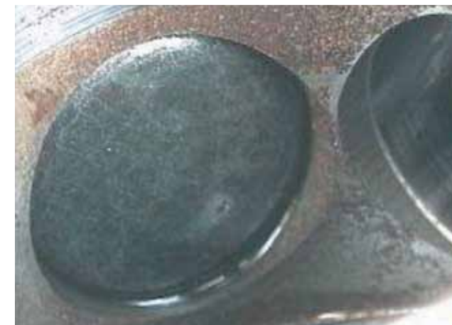
Korozja w obudowie pompy wysokiego ciśnienia
