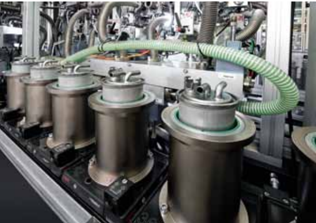
Testowanie szczelności za pomocą helu.
