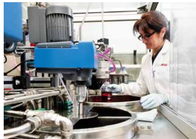
Optyczny pomiar liczby cząstek podczas testu skuteczności filtra
