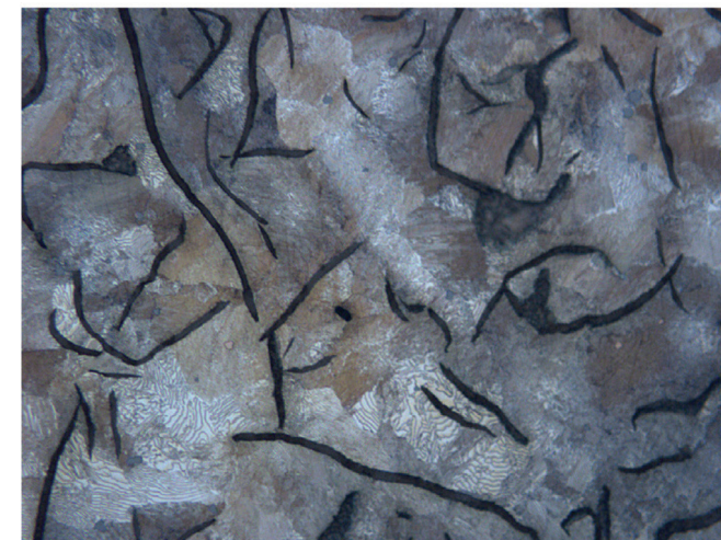
Mikrostruktura żeliwa z grafitem laminarnym
