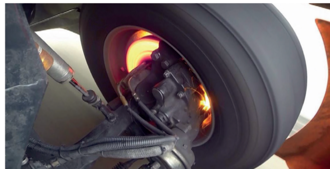
Wysokie temperatury powodują żarzenie tarczy hamulcowej
