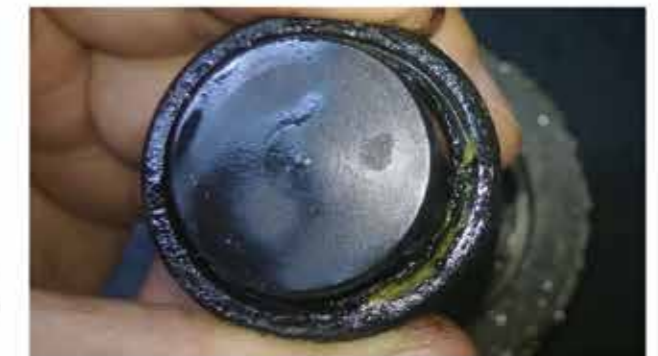
O-ring spęczniały w wyniku działania niewłaściwie zastosowanego medium roboczego
