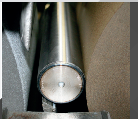
Szlifowanie, a następnie trwałe zabezpieczenie przed korozją
