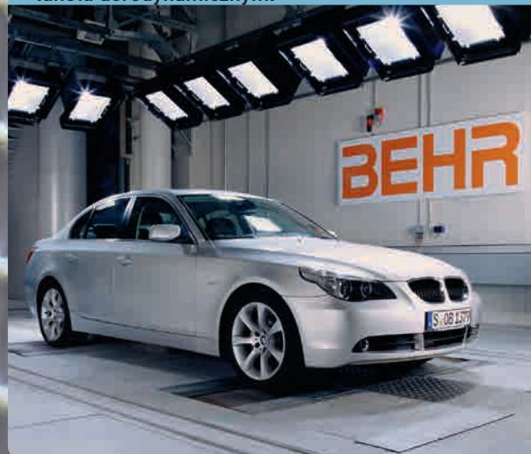
Testowanie produktów w klimatycznym tunelu aerodynamicznym.
