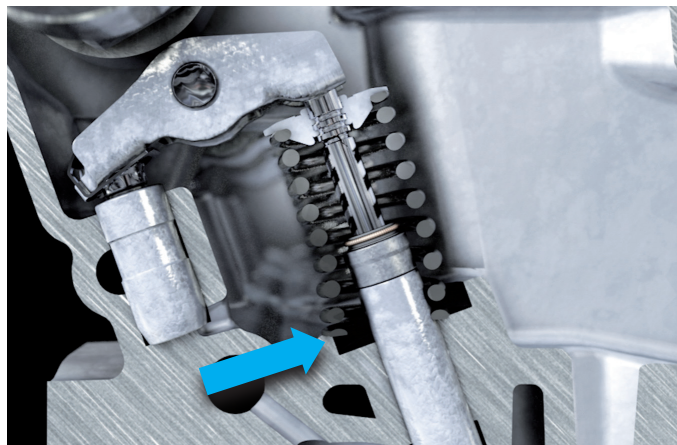
Zdjęcie 1: Ukośnie osadzona sprężyna zaworu
