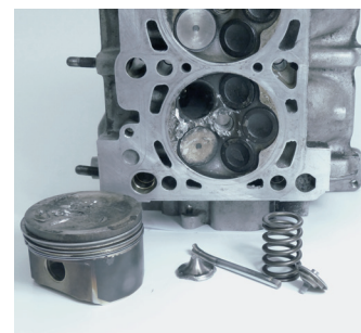
Zdjęcie 5: Typowy wygląd uszkodzenia po złamaniu zaworu
