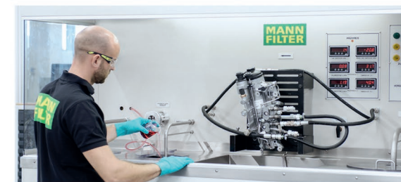
Sterowany komputerowo licznik cząstek mierzy wydajność filtracji PU 11 001 z
