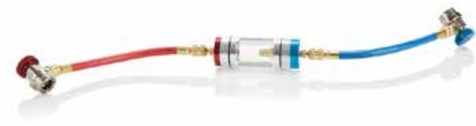
Zdj 4. Kontrola wziernikiem.
