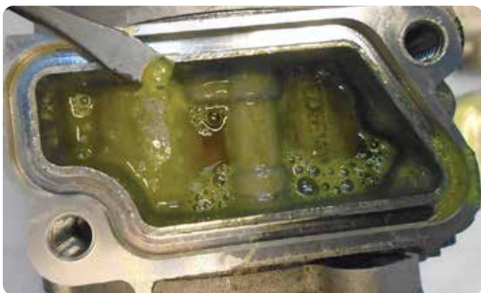
Zdj 3. Sekcja ssąca sprężarki.
