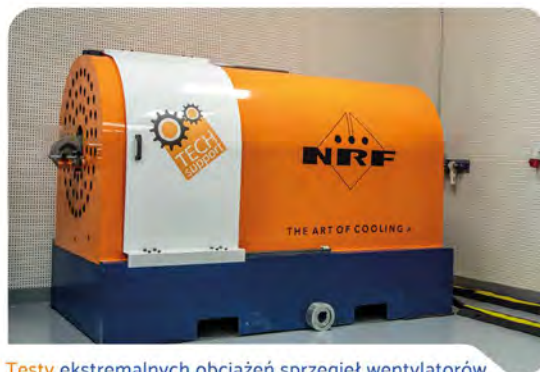
Testy ekstremalnych obciążeń sprzęgła wentylatorów żywotność w przy narażeniu na wysoki moment obrotowy
