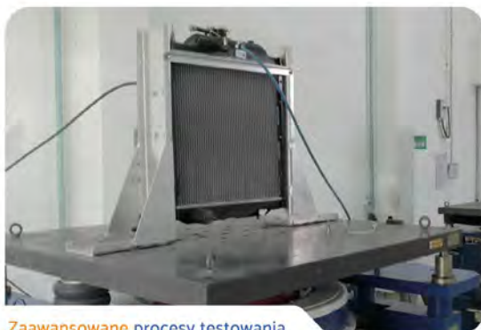
Zaawansowane procesy testowania cykle ciśnień, skrajne temperatury, odporność na wibracje
