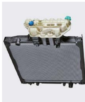
Zdjęcie 1: Chłodnica chłodziwa ze zbiornikiem wyrównawczym w pojeździe MAN
