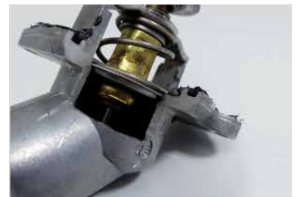
Ten termostat nie zamyka się, ponieważ użyto pasty uszczelniającej osadzającej się w korpusie.
