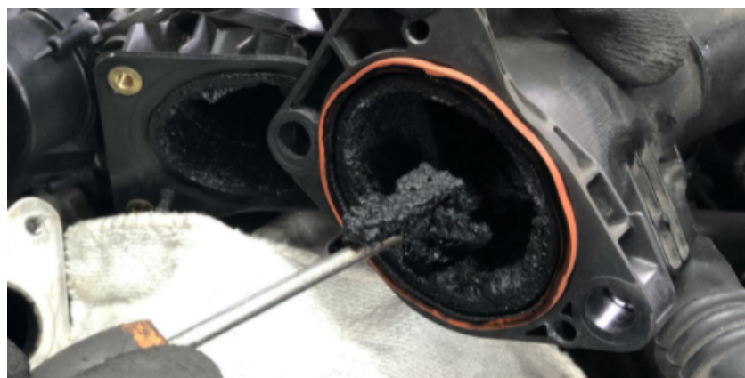
Zdj. 3 Przepuszczalność układu ograniczona przez nadmierne zanieczyszczenie
