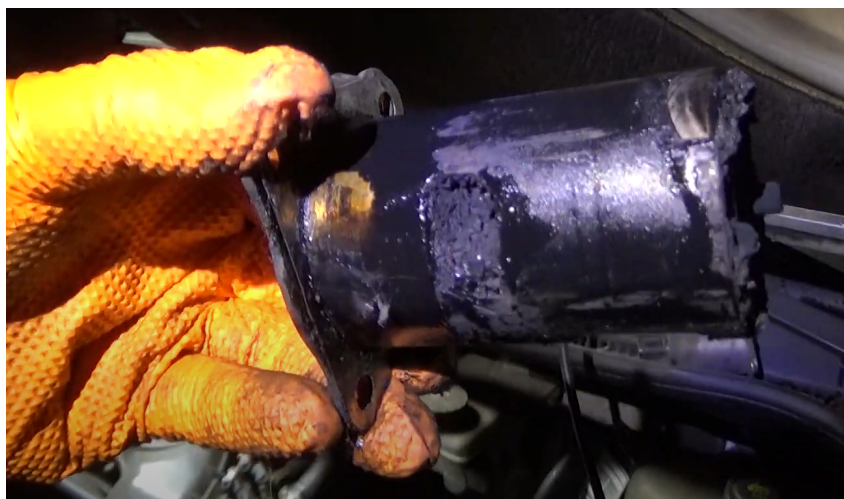
Zdj. 2 Zawór EGR wymontowany z pojazdu
