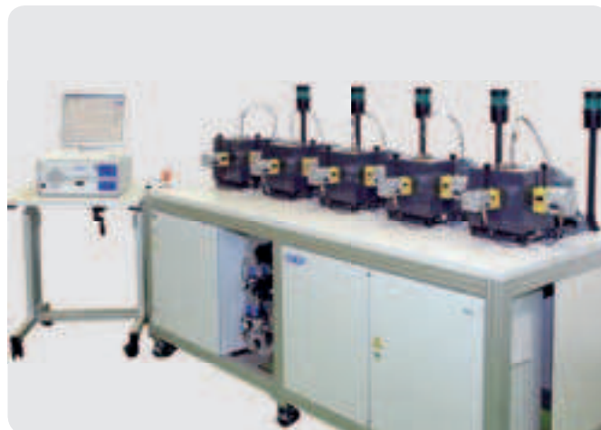
Stanowisko do przeprowadzania testu smaru metodą ROF+
