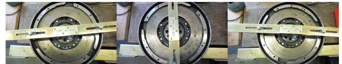
Rysunek 4: Uszkodzone DKZ: nieograniczony obrót masy wtórnej
