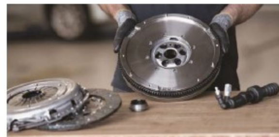
Tarcza sprzęgła powinna być sprawdzona przed montażem.
