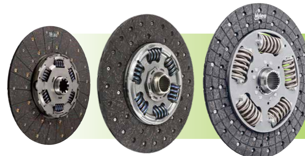
Porównanie konstrukcji tarcz w kolejnych technologiach: GD, TG, TH. Na zdjęciu po prawej widać nowe, opatentowane przez Valeo rowkowanie materiału ciernego zastosowane w tarczy typu TH.
