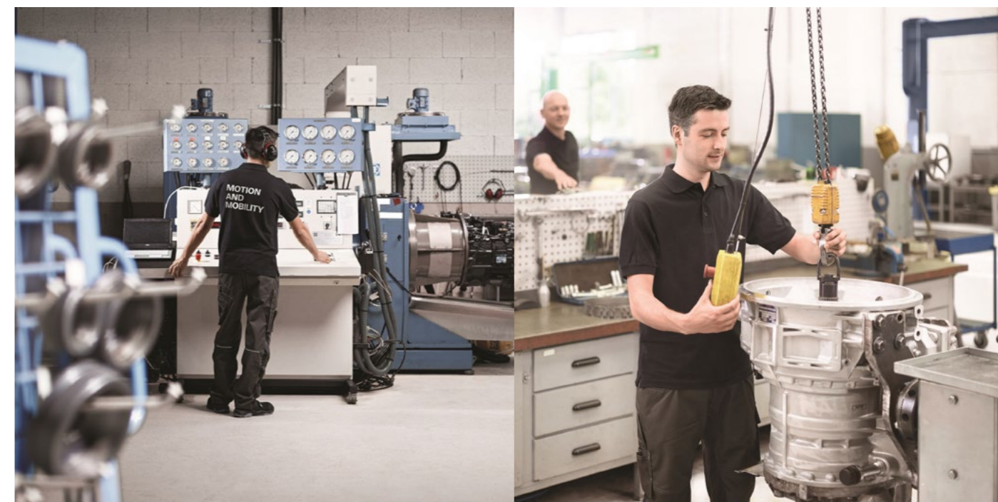
ZF Aftermarket opracował specjalną hamownię do testowania skrzyń biegów.
