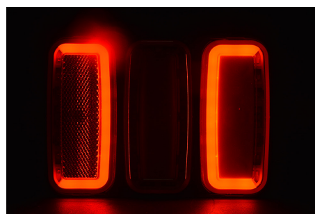
Tylne światło pozycyjne w dwóch modułach w kształcie dwóch odwróconych liter „C”
